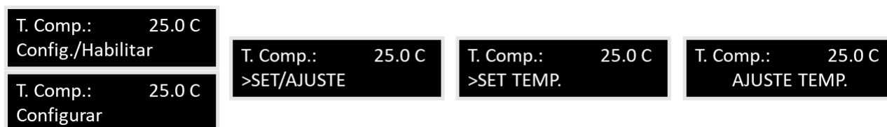
Figura 36 - Sequência de comandos para habilitar e configurar a compensação de temperatura.
