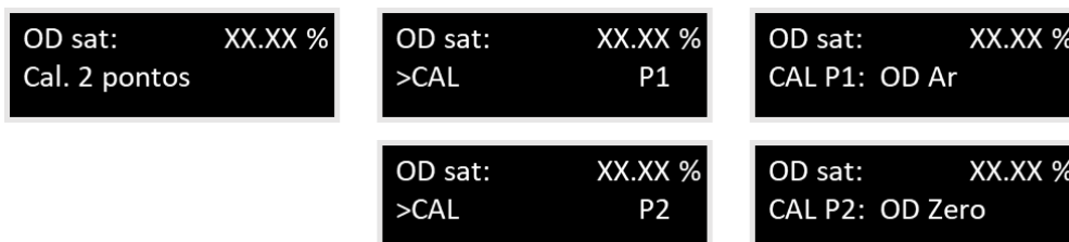
Figura 16 - Sequência de comandos para calibrar a dois pontos o sensor OD.
